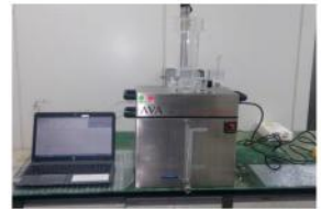
소성콘크리트 공극량 측정
